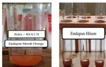
**Gambar 1. Hasil Uji Reaksi Warna KI 0,5 N**
